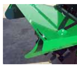
Deflector para graduar la anchura de reparto
