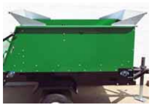
Extensión para cargar con pala
