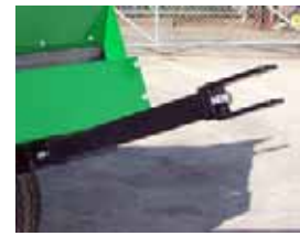
Enganche ajustable para ser remolcado por cualquier vehículo
