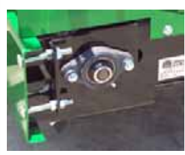
Ajuste de la cinta repartidora con 2 tornillos en cada lado
