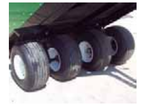
4 ruedas en el modelo 300 para repartir la carga
